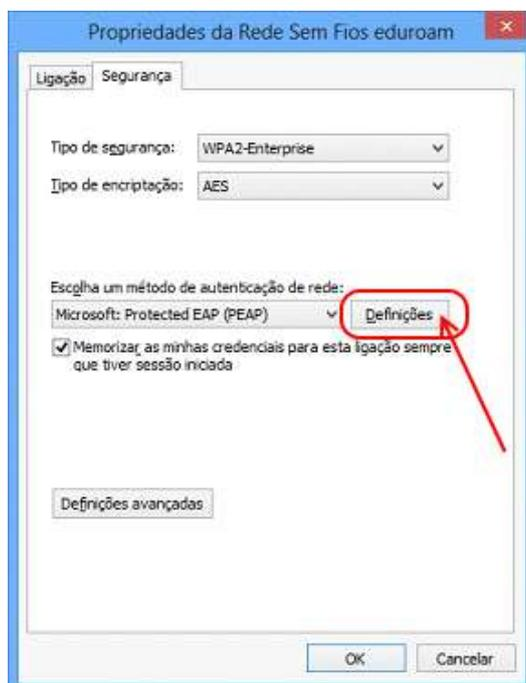
Figura 7 - Definições de encriptação.
